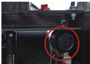
4 sygnał dźwiękowy sygnalizujący pełny pojemnik pyłu #2
