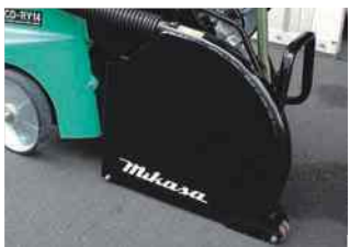
2 szczelna osłona ostrza absorbująca hałas
