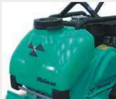
Zbiornik na wodę
