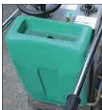
zbiornik na wodę z odpornego tworzywa
