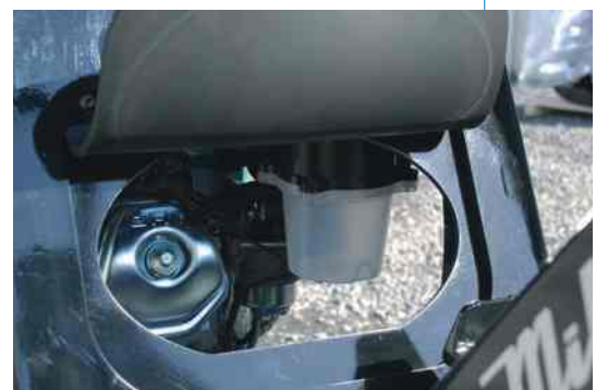
Filtr wstępny (cyklonowy) zdecydowanie zwiększa wydajność całego układu filtracji. Niezbędne do pracy w środowiskach zapylnych.
