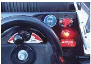
3 dioda ostrzegawcza sygnalizująca pełny pojemnik pyłu #2
